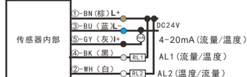
注意: 应用时4~20mA允许负载电阻≤400欧姆; 开关量输出负载≤50mA; IO LINK4号端子(黑线)进行C/Q通讯时开关量无效!
